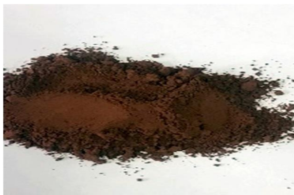
Рисунок 2 – Мелкодисперсная фракция осадка после выщелачивания обожженного железистого песка
