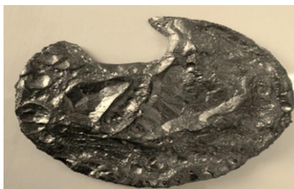
Рисунок 3 - Слиток чугуна полученный из железистого гидрогранатового шлама
