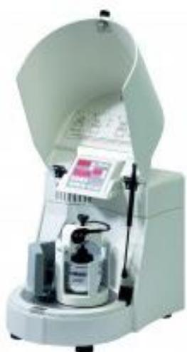
**Назначение:** сверхтонкое измельчение лабораторных проб от твердых до мягких.
