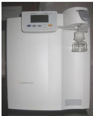
Предназначена для получения высокоочищенной воды для высокоточного оборудования и приготовления стандартных и референтных растворов.
