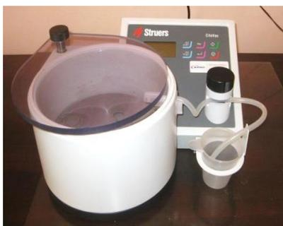
**Назначение:** заливка и пропитка смолами пористых конструкций, материалов, чувствительных к нагреву и прессовым усилиям для последующего изготовления их шлифов.
