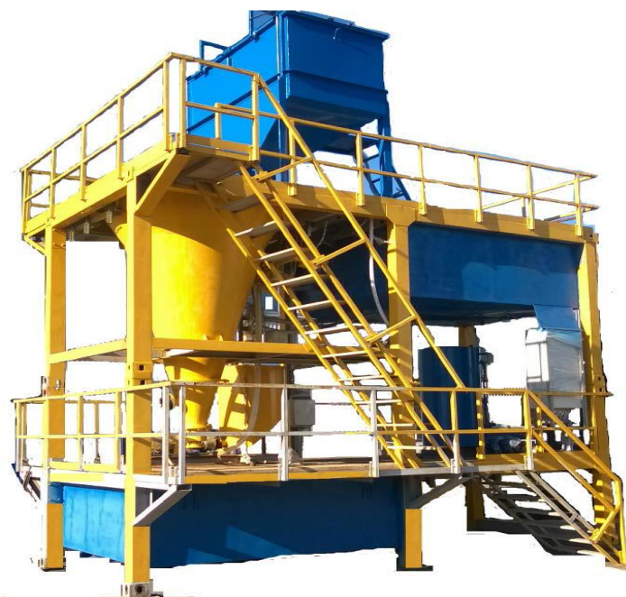
Рисунок 2 – Модульная установка интенсивного цианирования Август КШ-3
