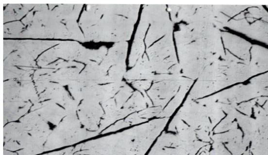
Рисунок 2 – Чугун с включениями и микротрещинами
