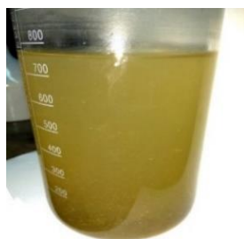
Рисунок 1 - Хлопьеобразование при взаимодействии КАКАО с канализационным стоком
